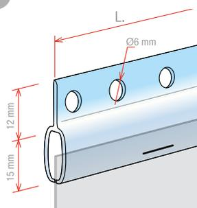
Trasparente, il poster viene inserito lateralmente a scorrimento e tenuto tramite punti metallici.
