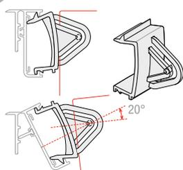
Per messaggi a bandiera con sistema di bloccaggio con foro, per profili porta etichette elettroniche. Con 2 posizioni: verticale o inclinato a 20°.
