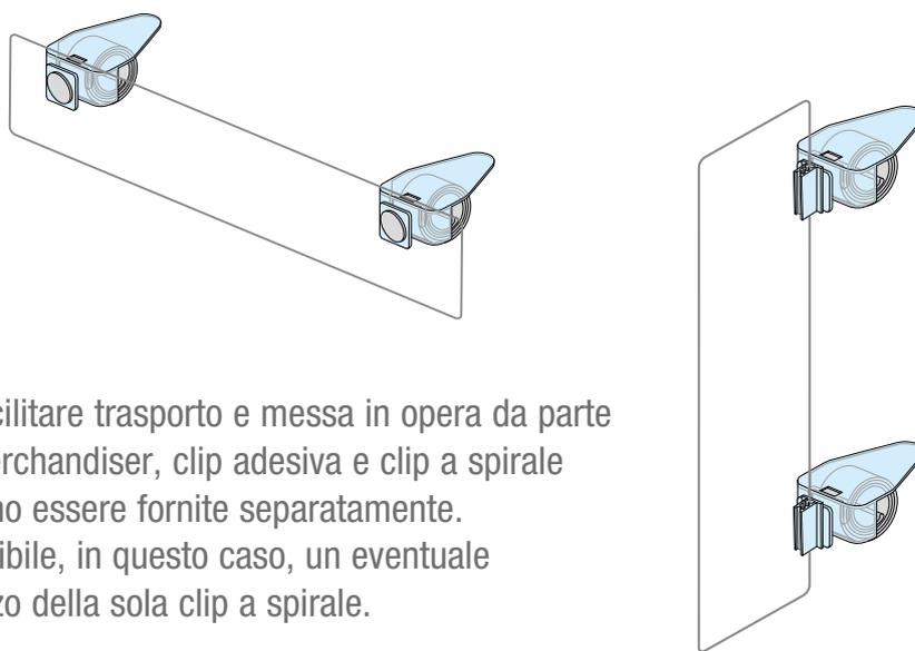
Per facilitare trasporto e messa in opera da parte dei merchandiser, clip adesiva e clip a spirale possono essere fornite separatamente. È possibile, in questo caso, un eventuale riutilizzo della sola clip a spirale.
